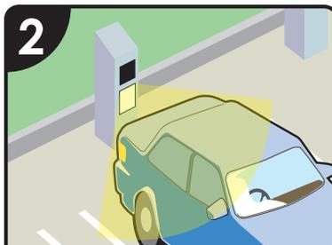
2 車室後方のカメラで車両ナンバーを認識し、課金を開始します。
